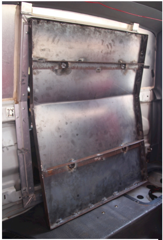
Anpassen der Sperre nach hinten als Schutztrennung zwischen Führerkabine und Wohnteil
